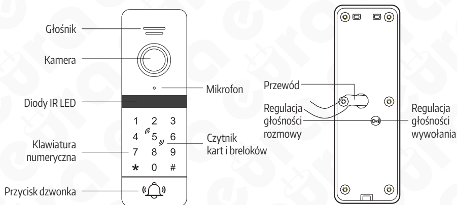
Rys. 1 Budowa kaseaty zewnętrznej
